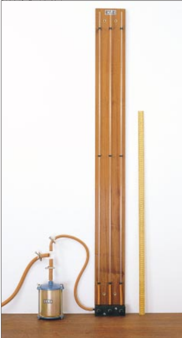
变水头渗透室及压力计
